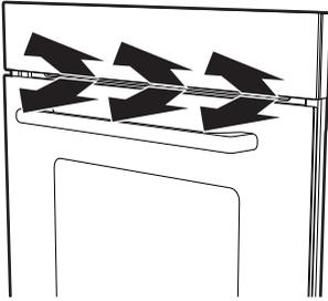
La ventola provvede a raffreddare il forno ed entra in funzione durante la cottura.
