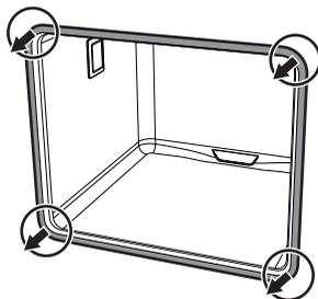
Per montare la guarnizione forno:
