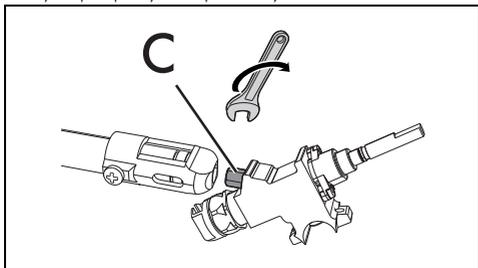
7. С помощью жесткого ключа снимите форсунки "С" и установите форсунки, подходящие для нового типа газа, следуя указаниям, приведенным в соответствующих таблицах (см. «Типы газа и страны принадлежности»).
