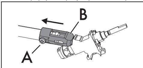
6. Отвинтите винт "А" и протолкните до упора регулятор воздуха "В".
