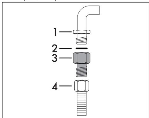
Аккуратно привинтите фитинг 3 к газовому патрубку 1 (резьба  $\frac{1}{2}$  дюйма ISO 228-1) прибора, проложив прокладку 2 из комплекта поставки. Нанесите изоляционный материал на резьбу патрубку 3, а затем заверните гибкий стальной шланг 4 на патрубке 3.
