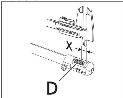
9. Отрегулируйте приток воздуха, сдвинув трубку Вентури "D" до получения расстояния "X", указанного в соответствующих таблицах (см. «Таблицы характеристик конфорки и форсунок», пункт "Первичный воздух (мм)", и закрепите ее винтом "А".
