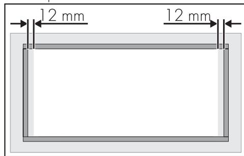
2. Приклейте ее, слегка нажимая, на поверхность внешнего периметра отверстия, выполненного в столешнице.
