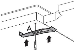
En la figura siguiente se indican los puntos de fijación de la cubierta a la encimera superior.
