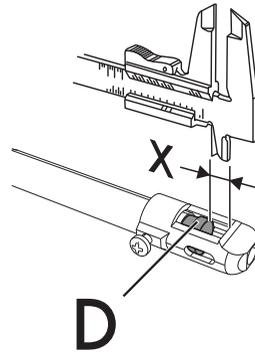
4. Ajuste la entrada de aire desplazando el tubo Venturi "D", hasta obtener la distancia "X" que figura en las tablas correspondientes (vea "Tabla de características de los quemadores e inyectores", en la opción "Aire primario (mm)"); a continuación, apriete el tornillo "A".
