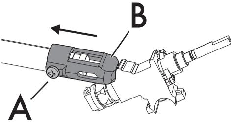
1. Afloje el tornillo "A" y empuje hasta el fondo el regulador del aire "B".
