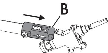
10. Отрегулируйте приток воздуха, сдвинув трубку Вентури "D" до получения расстояния "Х", указанного в соответствующих таблицах (см. «Таблицу характеристик конфорок и форсунок», пункт «Первичный воздух (мм)», и закрепите ее винтом "А".
