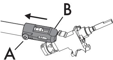
7. Отвинтите винт "А" и протолкните до упора регулятор воздуха "В".
