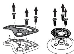
5. Снимите прокладки, имеющиеся на термопарах и свечах каждой конфорки.
