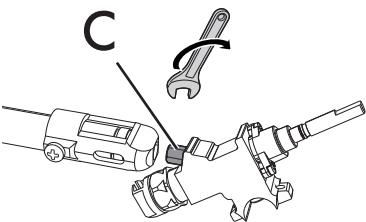
8. С помощью жесткого ключа снимите форсунки "С" и установите форсунки, подходящие для нового типа газа, следуя указаниям, приведенным в соответствующих таблицах (см. «Типы газа и страны принадлежности»).
