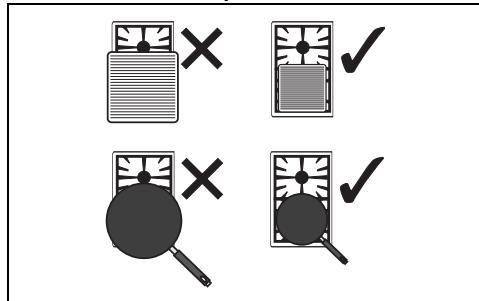
Во время приготовления пищи, чтобы избежать ожогов, повреждение варочной панели или столешницы, все емкости или сковороды-грили должны быть расположены в пределах периметра варочной панели.
