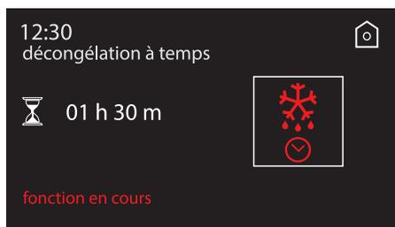
5. Au terme de la fonction, l'appareil émet un signal sonore et passe automatiquement à l'état de conservation ; il reste dans cet état tant que l'utilisateur n'interrompt pas la fonction au moyen de la touche
