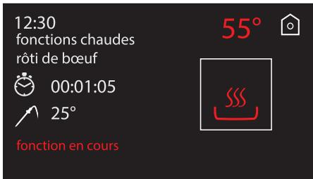
Lorsque la température actuelle à l'intérieur de l'aliment (indiquée à côté du symbole de la sonde, dans l'exemple 25°C) atteint la température cible (indiquée au-dessus du
