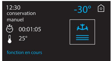
9. Lorsque la fonction est terminée, l'appareil émet un signal sonore, la barre de progression de la fonction et la température à atteindre disparaissent de l'afficheur.
