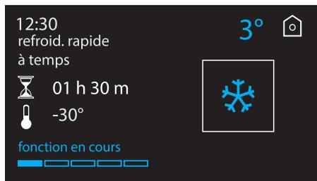
8. Lorsque la fonction est terminée, l'appareil émet un signal sonore, la barre de progression de la fonction et la température à atteindre disparaissent de l'afficheur.
