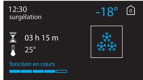
9. Au terme du temps, l'appareil émet un signal sonore, la barre de progression de la fonction et la température disparaissent de l'afficheur.
