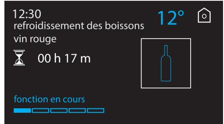
6. Lorsque le temps s'est écoulé et que la température présélectionnée est atteinte, l'appareil émet un signal sonore, la barre de progression de la fonction et la température à atteindre disparaissent de l'afficheur.
