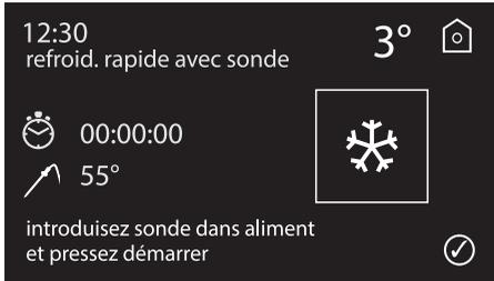
5. Une fois que la fonction a démarré, la page-écran suivante s'affiche. La page-écran reste active tant que la température indiquée à côté du symbole de la sonde (55°C) ne coïncide pas avec la température au-dessus du symbole de la fonction (3°C).
