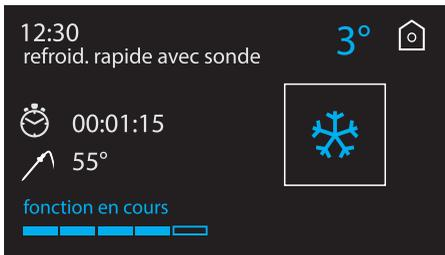
6. Dès que la température de 3°C est atteinte, l'appareil émet un signal sonore, la barre de progression de la fonction et la température à atteindre disparaissent de l'afficheur.
