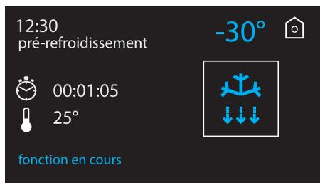
6. Lorsque la température sélectionnée est atteinte, l'appareil émet un signal sonore, la barre de progression de la fonction et la température à atteindre disparaissent de l'afficheur.
