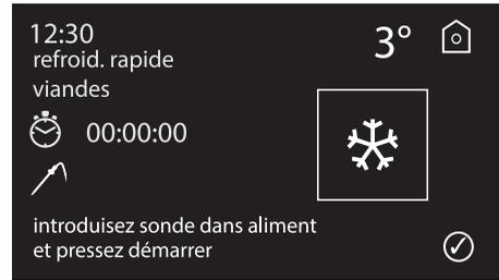
10. Une fois que la fonction a démarré, la page-écran suivante s'affiche. La page-écran reste active tant que la température indiquée à côté du symbole du thermomètre (25°C) ne coïncide pas avec la température au-dessus du symbole de la fonction (3°C).
