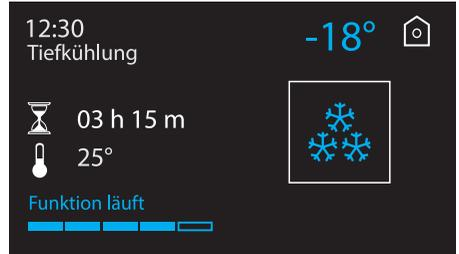
9. Nach Ablauf der Zeit löst das Gerät ein akustisches Signal aus; die Fortschrittsleiste der Funktion und die Temperatur werden nicht mehr angezeigt.
