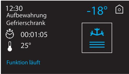
5. Bei Erreichen der Temperatur löst das Gerät ein akustisches Signal aus.
