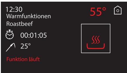
Wenn die aktuelle Temperatur im Lebensmittel (angezeigt neben dem Symbol der Sonde, im Beispiel 25 °C) die Zieltemperatur (angezeigt über dem
