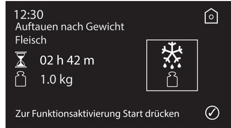
5. Nach erfolgtem Funktionsstart zeigt die Bildschirmseite die bis zum Ende der Funktion noch verbleibende Zeit an.
