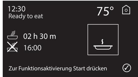
6. Das Gerät versetzt sich in den Modus der Aufbewahrung bei 3 °C, in Erwartung, die Uhrzeit für den Funktionsbeginn zu erreichen.
