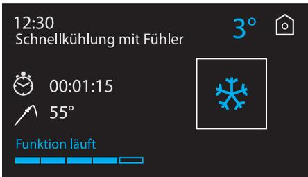
6. Sobald die Temperatur von 3 °C erreicht ist, löst das Gerät ein akustisches Signal aus, die Fortschrittsleiste der Funktion und die Temperatur werden nicht mehr angezeigt.
