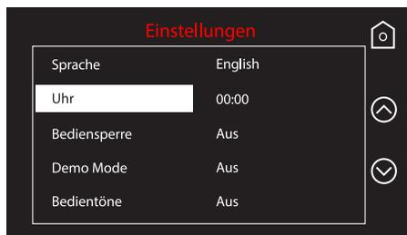
2. Die aktuelle Uhrzeit eingeben: Im Beispiel steht die aktuelle Uhrzeit auf 20:30, das Feld der Stunden drücken und 2 und 0 eingeben, dann auf das Feld der Minuten übergehen und 3 und 0 eingeben.
