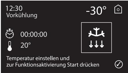
7. Nach der Bestätigung zeigt das Display an, dass die Vorkühlung der Zelle läuft.
