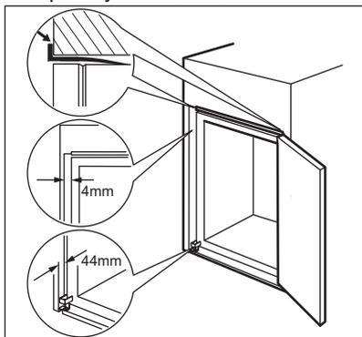
7. Закрепите прибор внутри ниши четырьмя винтами.
