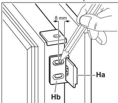
18. Снимите кронштейны и отметьте расстояние 8 мм от внешнего края дверцы: это место для гвоздя (К).
