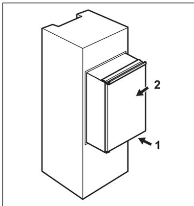
4. Сдвиньте прибор в направлении, указанном стрелками (2), к боковой стенке кухонного шкафа, на которой нет петли.
