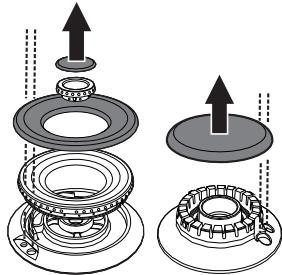
Перед тем, как включить конфорки варочной поверхности, убедитесь, что корончатые рассекатели и крышки на них установлены в соответствующих пазах. Положение отверстий конфорки должно совпадать со свечами и термопарами. Кроме того, необходимо проконтролировать, чтобы выступы корончатых рассекателей исправно входили в отверстия конфорки.
