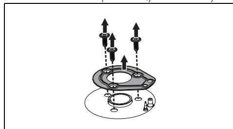
9. Удалите прокладки со свечей зажигания и термопар на каждой горелке.
