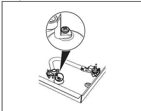
2. Удалите опору горелки и соответствующую трубку подвода газа.
