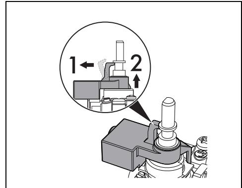
4. С помощью ключа на 7 мм снимите форсунку и замените ее на подходящую для нового типа газа, следуя указаниям, приведенным в соответствующих таблицах (см. «Типы газа и страны»).
