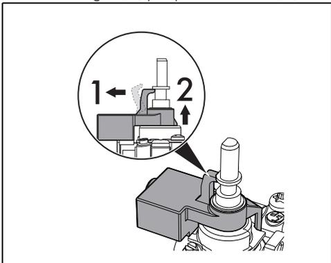
4. Con una chiave da 7 mm rimuovere l'ugello e sostituirlo con quello adatto al nuovo tipo di gas, seguendo le indicazioni riportate
