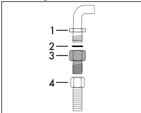
Avvitare accuratamente il raccordo 3 al raccordo gas 1 (filetto 1/2" ISO 228-1) dell'apparecchio interponendo sempre la guarnizione 2 in dotazione. Applicare del materiale isolante sul filetto del raccordo 3, dopodiché avvitare il tubo flessibile in acciaio 4 al raccordo 3.
