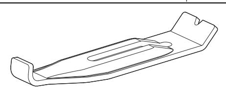
Чтобы правильно закрепить варочную панель на тумбе для встраивания, ввинтите крепежные кронштейны в специальные отверстия.
