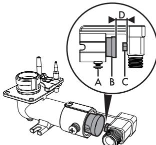
4. 1. Отверните винт А и задвиньте до упора регулятор воздуха В.
