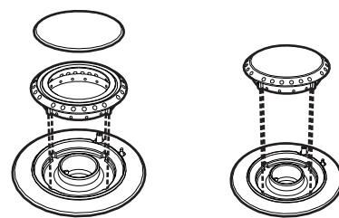
Перед тем, как включить конфорки варочной поверхности, убедитесь, что корончатые рассекатели и крышки на них установлены в соответствующих пазах. Положение отверстий конфорки должно совпадать со свечами и термопарами. Кроме того, необходимо проконтролировать, чтобы выступы корончатых рассекателей исправно входили в отверстия конфорки.
