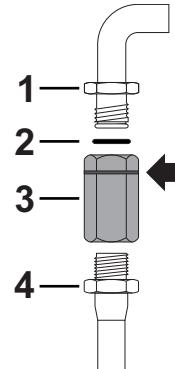
Нанесите изоляционный материал на резьбу газовой трубы 4 и заверните на неё переходник 3. Прикрутите стопор к подвижному патрубку 1 прибора, обязательно проложив прокладку 2 из комплекта поставки.
