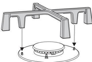
Удостоверьтесь, что решетки были просто отцентрированы на соответствующих горелках, чтобы они не находились в приподнятом или наклоненном положении; в противном случае следует повторить их установку.
