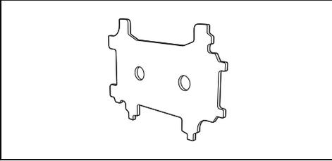
Útil para desmontar y volver a montar los quemadores de la encimera.
