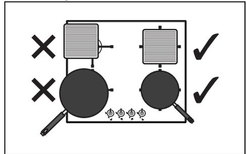
Durante la cocción, para evitar que la encimera o la placa de cocción se quemen o dañen, todos los recipientes o las planchas deben estar situados dentro del perímetro de la encimera de cocción.
