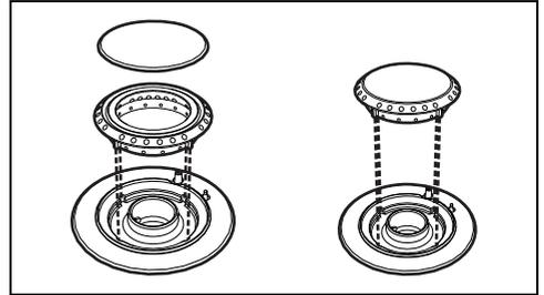
Antes de encender los quemadores de la encimera, verifique que los difusores de llama estén colocados en sus alojamientos con sus tapas correspondientes. Controle que los agujeros del quemador coincidan con las bujías y los termopares. Controle además que los acoples de los difusores de llama se introduzcan correctamente en los agujeros del quemador.
