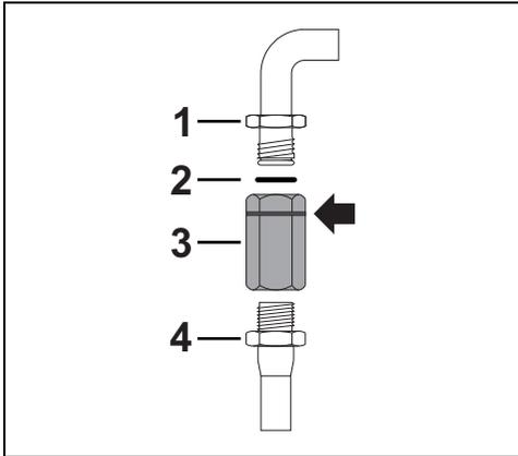
Aplique material aislante en la rosca del tubo del gas 4 y enrosque el adaptador 3. Enrosque el bloque al manguito móvil 1 del aparato interponiendo siempre la junta 2 que se suministra.
