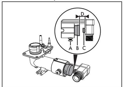
4. 1. Afloje el tornillo A y empuje hasta el fondo el regulador del aire B.
