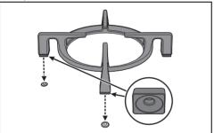
Удостоверьтесь, что решетки были просто отцентрированы на соответствующих горелках, чтобы они не находились в приподнятом или наклоненном положении; в противном случае следует повторить их установку. В случае, если заметите особую нестабильность кастрюли, проверьте корректную установку решеток.
