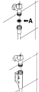
È possibile alimentare la lavastoviglie con acqua **che non superi i 60°C**. Alimentando l'apparecchio con acqua calda il tempo di lavaggio verrà abbreviato di circa 20 minuti; la sua efficacia sarà però lievemente ridotta. Il collegamento andrà effettuato alla presa domestica d'acqua calda con le stesse modalità descritte per il collegamento alla presa d'acqua fredda.
