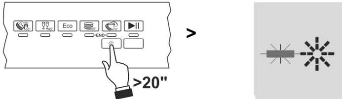
In seguito alla regolazione o alla visualizzazione di quella impostata è sufficiente lasciare inattivo il pulsante per alcuni secondi, la lavastoviglie ritorna automaticamente alla condizione standard uscendo dalla modalità di regolazione.
