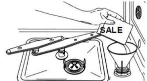
Affinché l'impianto di addolcimento dell'acqua possa funzionare senza problemi, l'apparecchio esegue un ciclo di rigenerazione dell'impianto a intervalli regolari.
