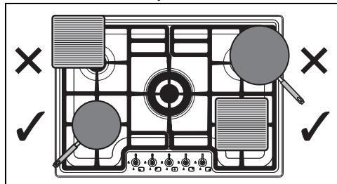
Во время приготовления пищи, чтобы избежать ожогов, повреждение варочной панели или столешницы, все емкости или сковороды-грили должны быть расположены в пределах периметра варочной панели.
