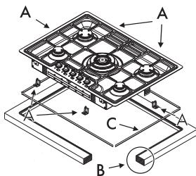
Эта встраиваемая модель требует выполнения на столешнице отверстия глубиной 3 мм (деталь "B" на рисунке выше). Прежде чем устанавливать прибор, следует поместить на отверстие изолирующую прокладку из комплекта поставки (C).
