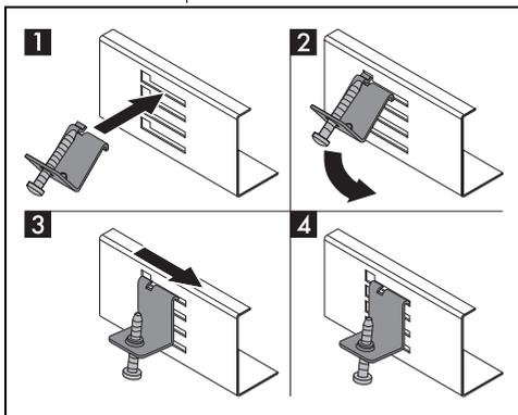
3. Apoie a placa sobre o vedante e com os parafusos e os grampos de fixação equipados (A), fixe a placa à estrutura de apoio até obter o nivelamento perfeito.
