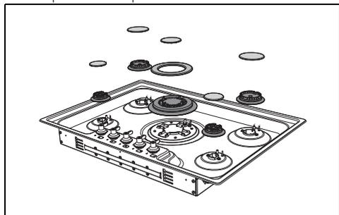
3. Com uma chave de tubo de 7 mm desapertar os injetores dos queimadores e proceder à substituição dos mesmos segundo o gás a utilizar (Consultar "Tabelas características dos queimadores e dos injetores").
