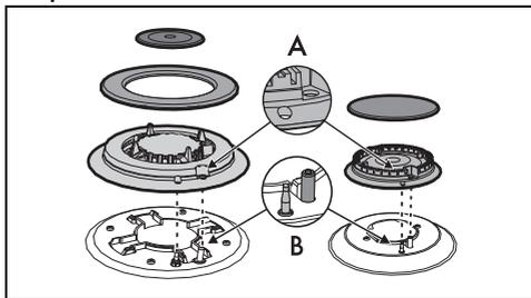
Antes de ligar os queimadores da placa, assegure-se de que os espalhadores estão colocados nas suas bases com as respetivas tampas. Preste atenção para que os orifícios 1 dos espalhadores de chama correspondam com as velas 3 e com os termopares 2.
