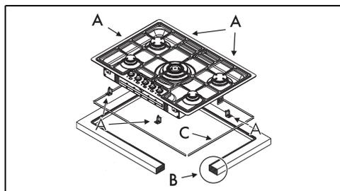
Este modelo de encaixe necessita de uma fresagem na bancada com uma profundidade igual a 3 mm (pormenor "B" da figura em cima). Antes de posicionar o aparelho, é necessário aplicar na fresagem a guarnição isolante fornecida (C).
