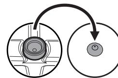
Под решетками имеются вогнутые силиконовые прокладки, которые необходимо расположить на соответствующем стопорном штифте, расположенном на варочной панели. Удовостерьтесь, что решетки были просто отцентрированы на соответствующих горелках, чтобы они не находились в приподнятом или наклоненном положении; в противном случае следует повторить их установку.
