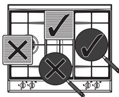
Во время приготовления пищи, чтобы избежать ожогов, повреждение варочной панели или столешницы, все емкости или сковороды-грили должны быть расположены в пределах периметра варочной панели.
