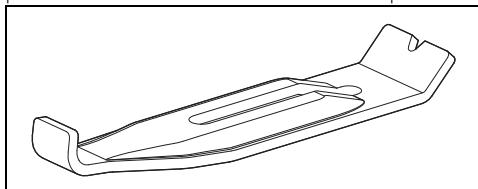
Чтобы правильно закрепить варочную панель на тумбе для встраивания, ввинтите крепежные кронштейны в специальные
