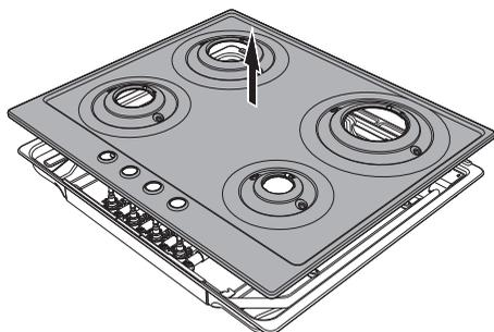
7. Снимите опорную пластину с панели.
