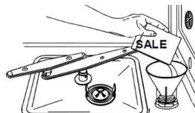
Para que o sistema de amaciamento da água funcione sem problemas, o aparelho executa um ciclo de regeneração do sistema em intervalos regulares.
