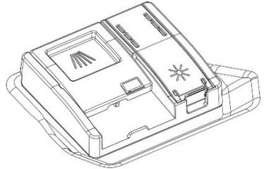
Der Klarspüler beschleunigt das Trocknen des Geschirrs und verhindert die Bildung von Flecken und Kalkablagerungen. Er wird während des letzten Spülgangs automatisch aus dem Behälter, der sich in der Innentür befindet, dem Wasser zugegeben.
