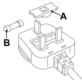
1. Den Deckel **A** entfernen und die Sicherung **B** herausnehmen.
