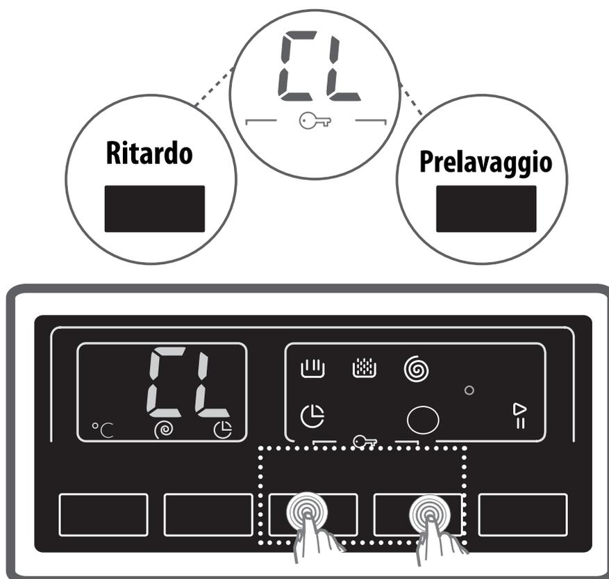
Attivando il blocco, sul display elettronico si accende il simbolo "CL". Una volta attivato il blocco di sicurezza, la pressione di un tasto farà lampeggiare il simbolo "CL" sul display elettronico.
