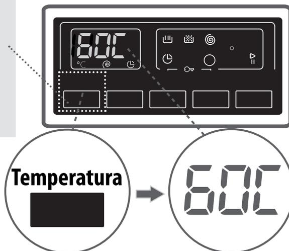
Questo valore può essere abbassato gradualmente tra la temperatura massima e il lavaggio a freddo (--), premendo il tasto di regolazione della temperatura dell'acqua.
