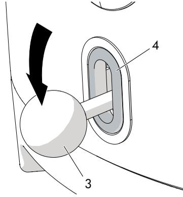
8. Quando começa a ferver a alavanca dispara para a posição de desligado e o led apaga.
