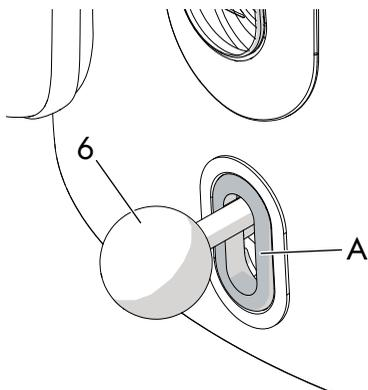
A alavanca de ligar/desligar ativa/interrompe o ciclo de fervura. Quando o fervedor está em funcionamento o led **A** acende ficando branco.
