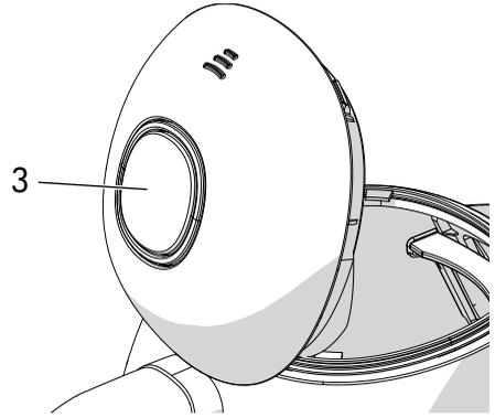
A tampa dispõe de um botão push-push (3), que lhe permite a abertura progressiva para evitar qualquer saída repentina de vapor quente.
