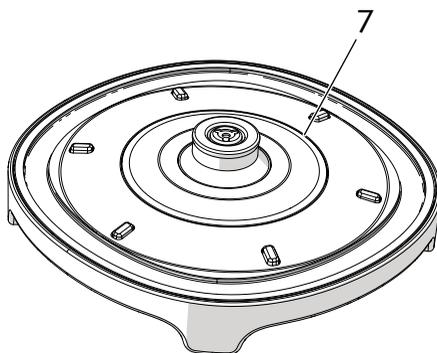
A ligação a 360° permite que colocar o fervedor na sua base em qualquer posição.
