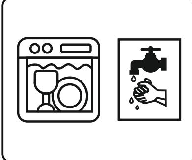
**IT** - Lavaggio filtro manualmente con detersivo neutro o in lavastoviglie a temperatura max. 70°C,in assenza di stoviglie. Lavare ogni tre mesi per un massimo di 12 lavaggi. L'eventuale decolorazione del filtro non ne compromette la funzionalità.
