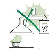
Relier l'aspirateur au conduit de cheminée avec un tube d'un diamètre minimum de 120 mm. Le parcours des fumées doit être le plus court possible.
