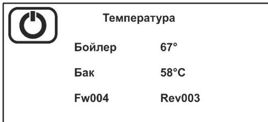
Нажмите , чтобы отобразить температуру в бойлере и в баке.
