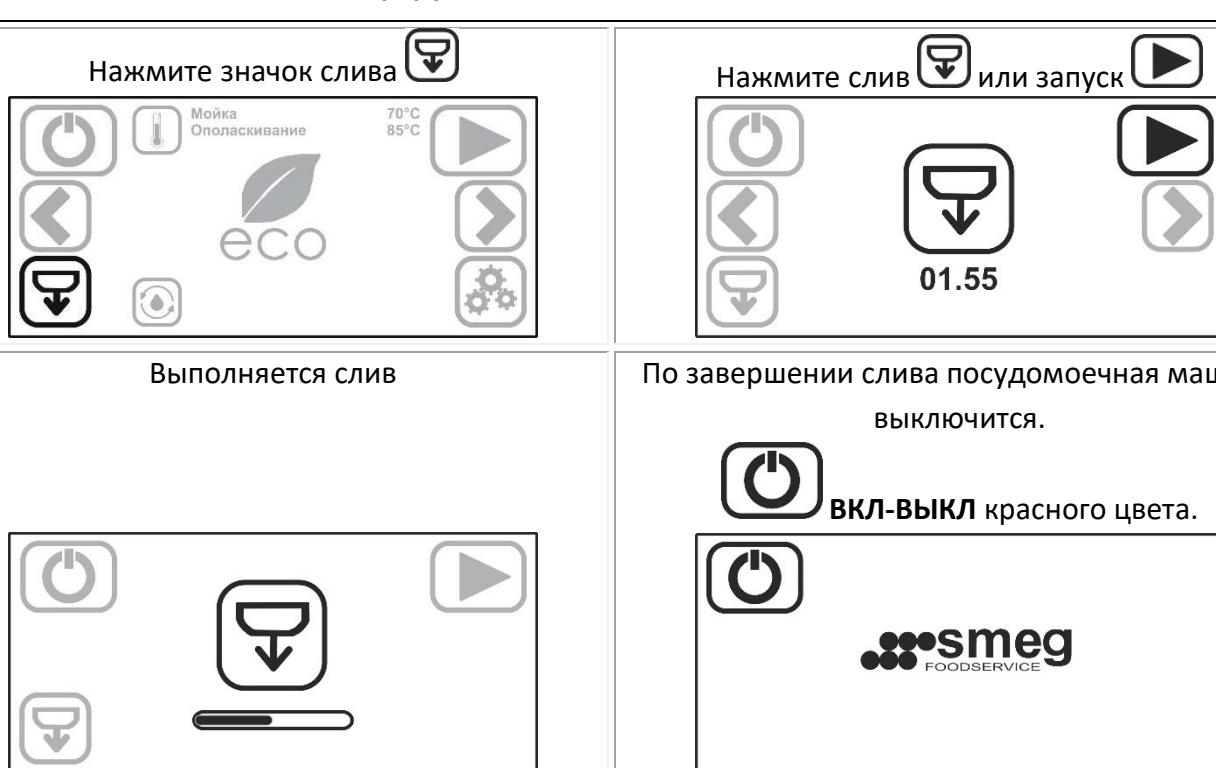
**!** Не выключать машину с водой в баке, всегда выполнять слив.
