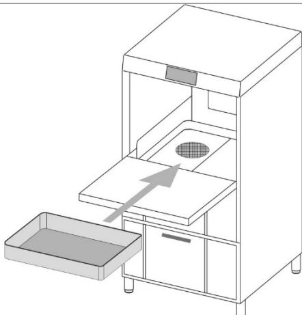
**Загрузить посуду и закрыть капот для запуска программы.** Включается светодиод L2.
