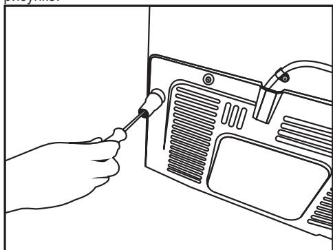
Для вертикальной регулировки дверей ,
