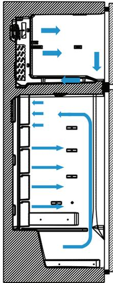
tiempo, se expulsa aire por los orificios del conducto de aire para que el proceso de refrigeración se complete debidamente en el refrigerador. Los orificios del conducto de aire están diseñados de tal modo que la distribución de aire sea homogénea en este compartimento.
