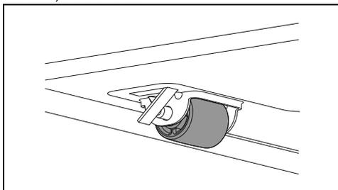
Contudo, aconselha-se a prestar muita atenção durante a deslocação, para que o deslizamento não danifique o pavimento (por exemplo, se o frigorífico estiver colocado sobre soalho).
