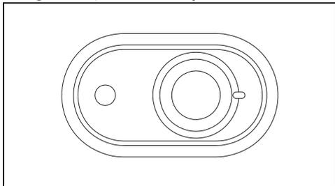
Rodar o manípulo do termóstato da posição ● (mínimo) para **5** (máximo) conforme a temperatura desejada.
