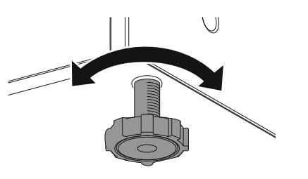
Для выравнивания прибора по горизонтали
