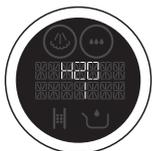
Машина установлена по умолчанию на «уровень жесткой воды». Машину можно настроить в зависимости от фактической жесткости используемой воды, что позволит сократить количество циклов по декальцификации воды. Если показатель жесткости воды неизве-
