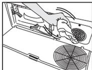
Se observar acumulação de fibras na tampa do ventilador e no resguardo, retirar com um pano.
