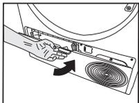
Depois de concluído o processo de limpeza, colocar a tampa do defletor de ar no lugar, mover os trincos para a fechar e fechar o resguardo.
