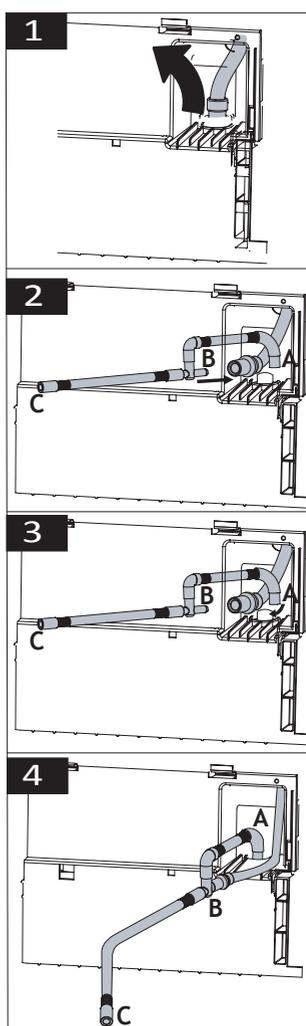
1 Puxe a mangueira pela parte de trás do produto com as mãos de modo a desligá-la de onde está encaixada. Não use ferramentas para retirar a mangueira.
