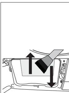
Limpar a fibra na superfície metálica do condensador com um pano húmido ou com a escova do defletor de ar na direção de cima para baixo.
