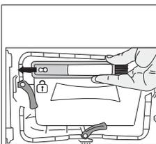
Puxar a escova para a esquerda para a retirar. É possível usar a escova de limpeza para limpar o filtro, a superfície metálica do condensador e a fibra acumulada na porta.
