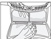
Une couche peut se former sur les pores du filtre et entraîner un bouchage du filtre après avoir utilisé le sèche-linge pendant un certain temps. Lavez le filtre à l'eau chaude pour enlever la couche qui se forme sur la surface du filtre. Séchez le filtre à peluche complètement avant de le réinstaller.
