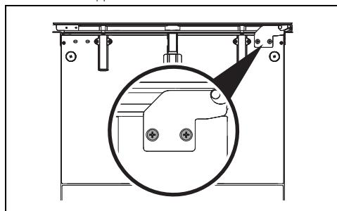
2. снимите два винта верхней петли.
