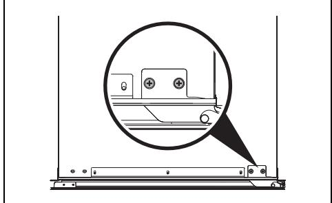
3. снимите дверь прибора и положите ее на ткань.
