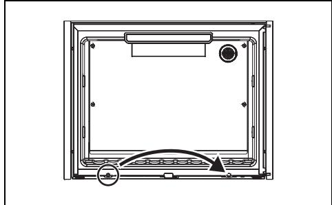
8. вновь установите дверь на прибор и закрепите верхние и нижние петли с помощью ранее снятых винтов.
