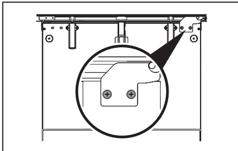
2. снимите два винта верхней петли.
