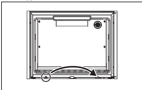
8. вновь установите дверь на прибор и закрепите верхние и нижние петли с помощью ранее снятых винтов.
