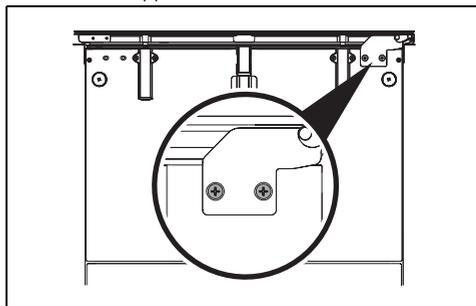
2. снимите два винта верхней петли.
