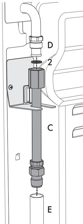
5. Нанесите изолирующий материал на резьбу удлинителя **C**, затем навинтите гибкий шланг **E**.
