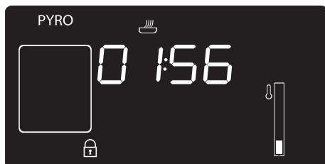
1. На дисплее появится надпись **PYRO ECO** или **PYRO ECO** и оставшееся до окончания процедуры время, что означает, что прибор выполняет цикл автоматической очистки.
