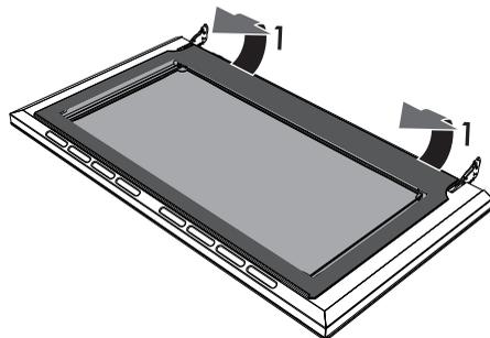
2. Выньте внутреннее стекло из передней рамки (2) чтобы снять его с дверки.
