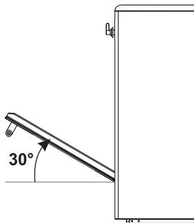
3. Чтобы снова установить дверцу, вставьте шарниры в соответствующие пазы, расположенные на духовке, так чтобы шлицы **A** полностью вошли в пазы. Опустите дверцу вниз, установите ее и извлеките штифты из отверстий петель.
