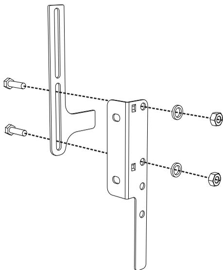
5. Выровняйте основание крепежной скобы до пола и затяните винты, фиксируя данные размеры.
