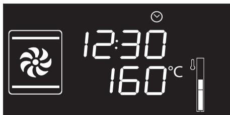
При каждом нажатии ручки температуры во время действия одной из функций показываются значения параметров функции в приведенном ниже порядке.
