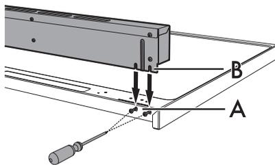
4. Закрепите доборную планку на панели с помощью ранее открученных четырех винтов.
