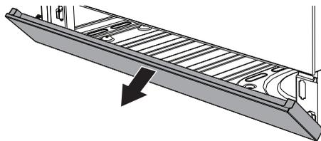
3. Чтобы закрыть отсек для принадлежностей, приподнимите дверку, пока не услышите щелчок.
