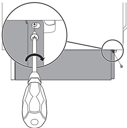
5. Закрепите боковой плинтус к прибору при помощи ранее снятого винта.
