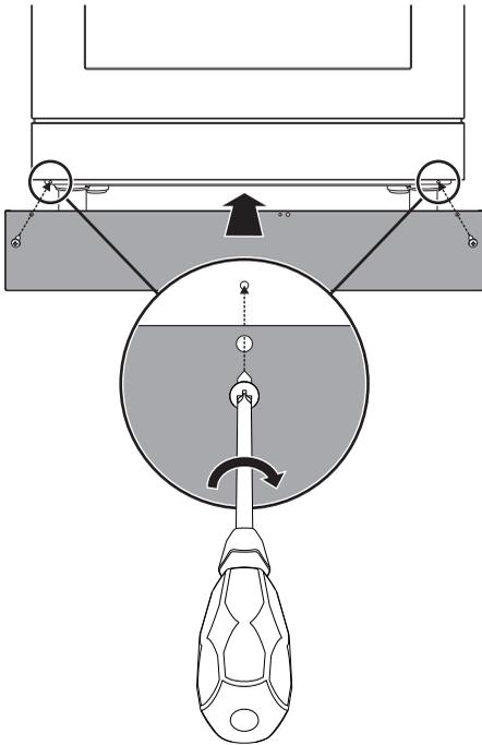
3. Закрепите фронтальный плинтус к прибору при помощи ранее снятых винтов.
