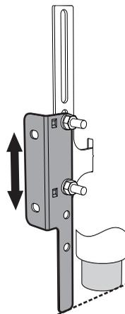
4. Выровняйте основу крюка крепежной скобы с основой отверстия пластины крепления к стене.
