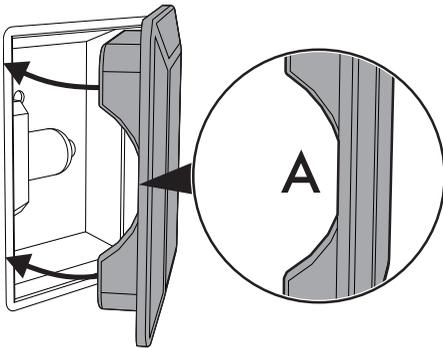
7. Нажмите на крышку таким образом, чтобы она плотно прилегала к патрону лампочки.
