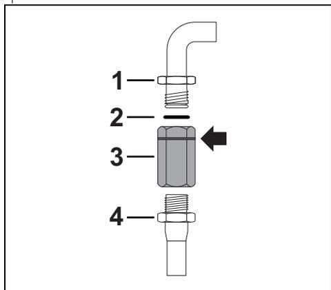
Нанесите изоляционный материал на резьбу газовой трубы 4 и заверните на ней переходник 3. Прикрутите стопор к подвижному патрубку 1 прибора, обязательно проложив прокладку 2 из комплекта поставки.
