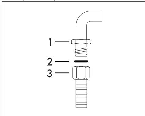
Аккуратно навинтите патрубков 3 на газовый патрубков 1 прибора, обязательно проложив прокладку 2 из комплекта поставки.
