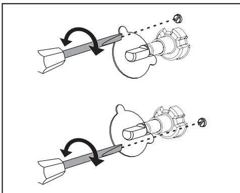
Разожгите конфорку и установите ее на минимальное положение. Снимите ручку газового крана, после чего ослабьте или затяните регулировочный винт, находящийся сбоку от стержня крана (в зависимости от модели), настолько, чтобы получить равномерное малое пламя.
