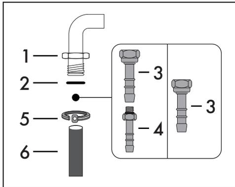
Аккуратно заверните фитинг 3 на газовом патрубке 1 (резьба 1/2 дюйма ISO 228-1) прибора, проложив прокладку 2. В соответствии с диаметром используемой газовой трубы можно привинтить и фитинг 4 к фитингу 3.
