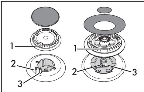
Перед тем, как включить конфорки варочной поверхности, убедитесь, что корончатые рассекатели и крышки на них установлены в соответствующих пазах. Следите за тем, чтобы отверстия «1» рассекателей совпадали со свечами «3» и термопарами «2».
