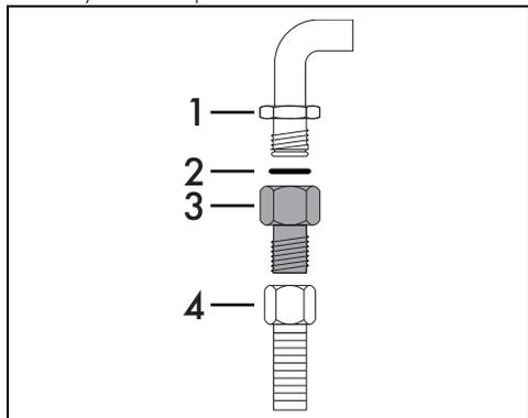
Аккуратно привинтите фитинг 3 к газовому патрубку 1 (резьба 1/2 дюйма ISO 228-1) прибора, проложив прокладку 2 из комплекта поставки. Нанесите изоляционный материал на резьбу патрубку
