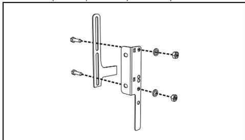
4. Выровняйте основу крюка крепежной скобы с основной отверстием пластины крепления к стене.
