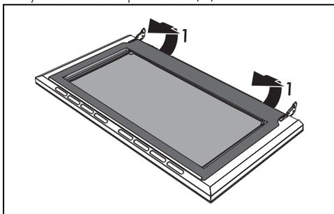
4. Выньте внутреннее стекло из передней рамки (2), чтобы снять его с дверцы.
