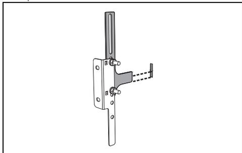
5. Выровняйте основание крепежного кронштейна с полом и затяните винты, фиксируя данные размеры.
