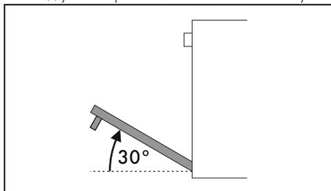
3. Чтобы снова установить дверцу, вставьте шарниры в соответствующие пазы, расположенные на духовке, так чтобы шлицы **A** полностью вошли в пазы.
