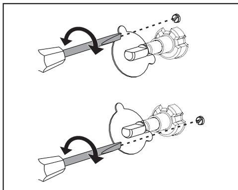
Acenda o queimador e coloque-o na posição de mínimo. Extraia o botão da torneira de gás e rode o parafuso de ajuste que se encontra ao lado da haste da torneira (conforme os modelos), até obter uma chama mínima regular. Volte a montar o botão e verifique a estabilidade da chama do queimador. Rode rapidamente o botão da posição de máximo para a de mínimo: a chama não deverá apagar-se. Repita a operação em todas as torneiras de gás.
