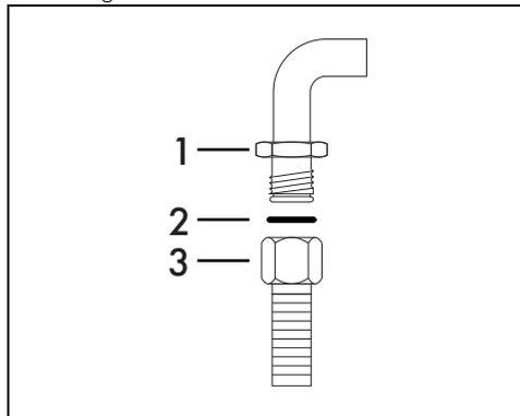
Enrosque de forma precisa a conexão 3 à conexão de gás 1 do aparelho, interpondo sempre o vedante 2 fornecido.
