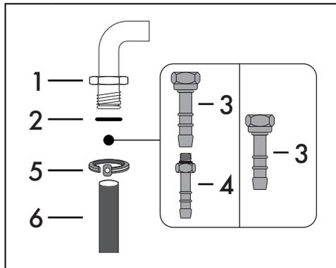
Enrosque de forma precisa o adaptador de mangueira 3 à ligação de gás 1 (rosca de 1/2" ISO 228- 1) do aparelho interpondo o vedante 2. De acordo com o diâmetro do tubo de gás utilizado é possível enroscar também o adaptador de mangueira 4 ao adaptador de mangueira 3.
