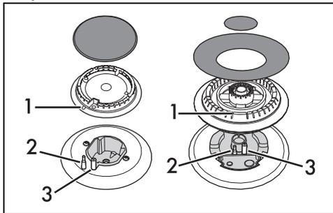
Antes de acender os queimadores da placa, assegure-se de que os espalhadores estejam colocados nas suas bases com as respetivas tampas. Preste atenção para que os orifícios 1 dos espalhadores de chama correspondam com as velas 3 e com os termopares 2.
