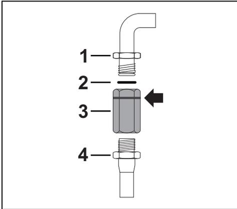
Aplique material isolante na rosca da conexão do tubo de gás 4 e enrosque o adaptador 3. Enrosque o bloco à conexão móvel 1 à do aparelho, interpondo sempre o vedante 2 fornecido.
