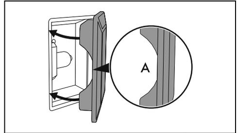
7. Pressione totalmente a tampa de forma a que encaixe perfeitamente no suporte da lâmpada.
