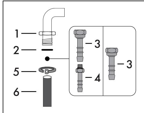
Аккуратно заверните фитинг 3 на газовом патрубке 1 (резьба ½ дюйма ISO 228-1) прибора, проложив прокладку 2. В соответствии с диаметром используемой газовой трубы можно привинтить и фитинг 4 к фитингу 3.
