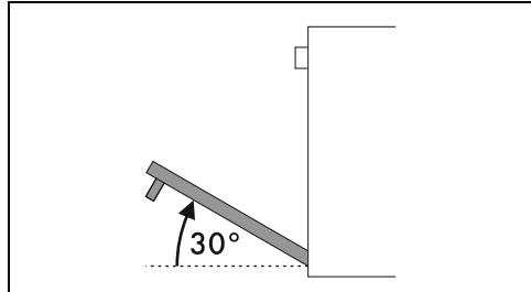
3. Чтобы снова установить дверцу, вставьте шарниры в соответствующие пазы, расположенные на духовке, так чтобы шлицы A полностью вошли в пазы.
