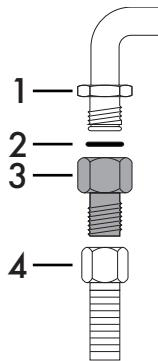
Аккуратно привинтите фитинг 3 к газовому патрубку 1 (резьба ½ дюйма ISO 228-1) прибора, проложив прокладку 2 из комплекта поставки. Нанесите изоляционный материал на резьбу патрубка
