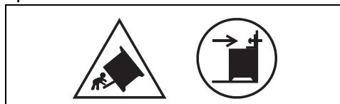
Вышеуказанные символы касаются опасности, вызванной отсутствием устройств стабилизации, и важности их правильной установки.
