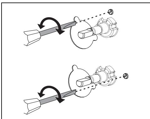
Разожгите конфорку и установите ее на минимальное положение. Снимите ручку газового крана, после чего ослабьте или затяните регулировочный винт, находящийся сбоку от стержня крана (в зависимости от модели), настолько, чтобы получить равномерное малое пламя.
