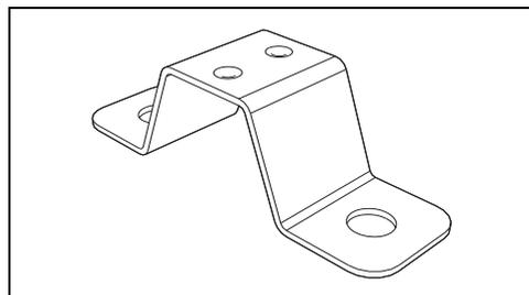
В случае подключения посредством кабеля с внутренним сечением на 10 кв. мм для его правильного крепления необходимо заменить уже установленную скобу на скобу из комплекта поставки.
