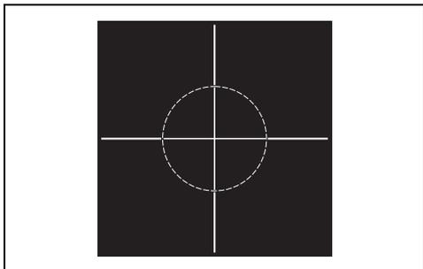
As panelas com diâmetros inferiores podem não ser detetadas e, por conseguinte, não ativar o indutor.
