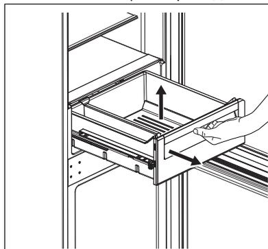
2. При закрывании дверцы задвиньте направляющие внутрь корпуса во избежание повреждения прибора.
