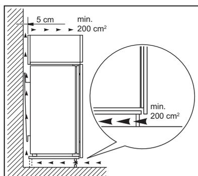
**!** **ПРЕДУПРЕЖДЕНИЕ** При установке см. инструкции по установке.
