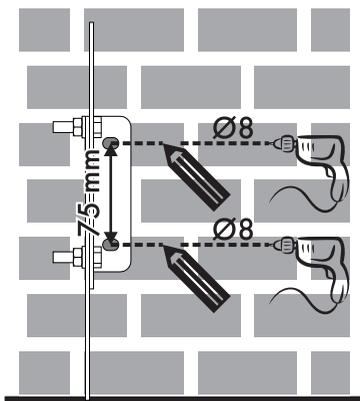
8. Após realizar os furos na parede, utilize as buchas com parafusos para fixar o suporte à parede.
