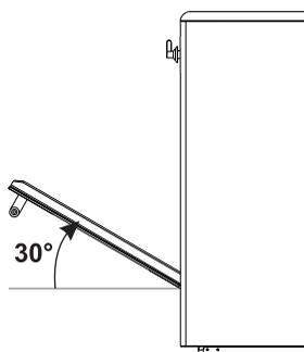
3. Para voltar a montar a porta, introduza as dobradiças nas respetivas fendas situadas no forno assegurando-se de que os sulcos **A** fiquem totalmente apoiados nas fendas. Baixe a porta e em seguida remova os pernos dos orifícios das dobradiças.
