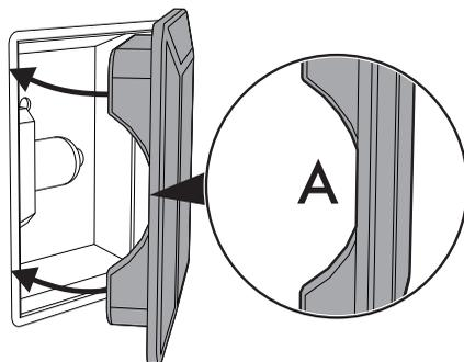
7. Pressione totalmente a tampa de forma a que encaixe perfeitamente no suporte da lâmpada.
