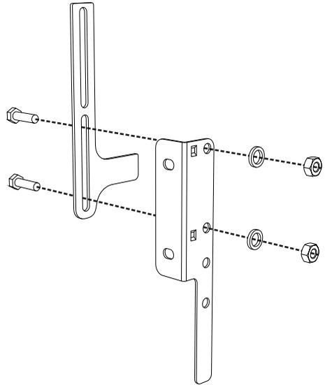
4. Alinhe a base do gancho do suporte de fixação à base do corte da pequena chapa de fixação à parede.
