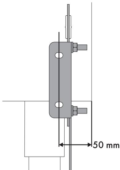
7. Desloque o suporte na parede e marque a posição dos furos a realizar na parede.
