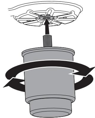
Para obter uma maior estabilidade, é indispensável que o aparelho esteja perfeitamente nivelado com o pavimento. Enrosque ou desenrosque os pés na parte inferior até nivelar e estabilizar o aparelho no pavimento.
