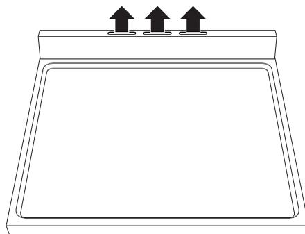
A ventoinha refrigera o aparelho e entra em funcionamento durante a cozedura. O funcionamento da ventoinha provoca um fluxo normal de ar que sai da parte posterior do aparelho e que pode continuar por mais algum tempo mesmo depois do desligamento.
