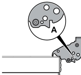
2. Возьмите дверцу за обе стороны двумя руками, приподнимите ее под углом приблизительно  $30^\circ$  и извлеките.
