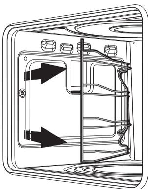
2. Вытащить ее из гнезд, расположенных в задней части.
