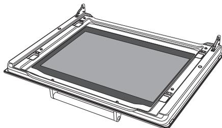
5. Установите внутреннее стекло. Обращая внимание на тщательную центровку 4 стержней, вставьте их в гнезда на дверце духовки, слегка надавив на них.
