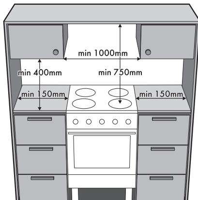
В случае установления вытяжки над варочной панелью, рекомендуется обращаться к руководству по установке вытяжки, чтобы определить правильное расстояние.
