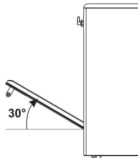
3. Чтобы снова установить дверцу, вставьте шарниры в соответствующие пазы, расположенные на духовке, так чтобы шлизы **A** полностью вошли в пазы. Опустите дверцу вниз, установите ее и извлеките штифты из отверстий петель.
