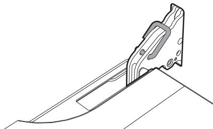
2. Возьмите дверцу за обе стороны двумя руками, приподнимите ее под углом приблизительно  $30^{\circ}$  и извлеките.
