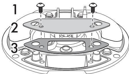
3. Посредством ключа 7 мм замените форсунку с учетом используемого вида газа.
