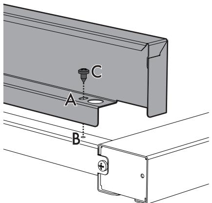
2. Закрепить защитную планку на панели, завинтив винты **C**.
