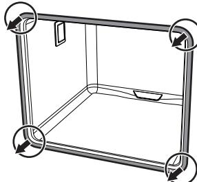
Для поддержания прокладок в чистоте пользоваться неабразивной губкой и прохладной водой. Исправные прокладки должны быть мягкими и эластичными.
