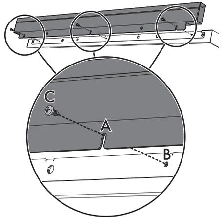
3. Com a ajuda de uma chave de fendas fixe o friso na placa de base com os parafusos (**C**) em dotação.
