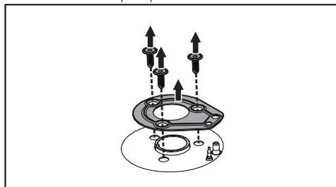
9. Déposez les joints des bougies et thermocouples de chaque brûleur.
