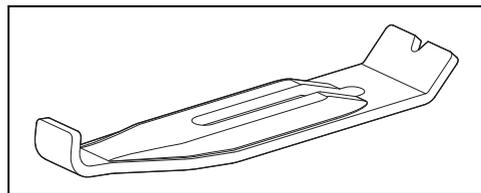
Vissez les pattes de fixation dans les trous prévus pour fixer correctement la plaque de
