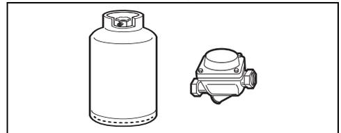
Utilisez un régulateur de pression et réalisez le raccordement à la bouteille conformément aux prescriptions établies par les normes en vigueur. La pression d'alimentation doit respecter les valeurs indiquées dans les « Tableaux des caractéristiques des brûleurs et injecteurs ».
