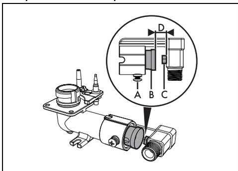
6. 1. Desserrez la vis A et poussez à fond le régulateur d'air B.
