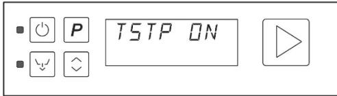
**При настройке на “вкл.” = минимальная температура ополаскивания** соответствует настроенной (см. температуру бойлера выше), вне зависимости от температуры поступающей воды; номинальная продолжительность цикла может увеличиваться на несколько секунд.
