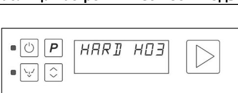
При наличии показателей выше 60°f следует использовать наружное устройство для подготовки воды и **настроить периодичность регенерации на**
