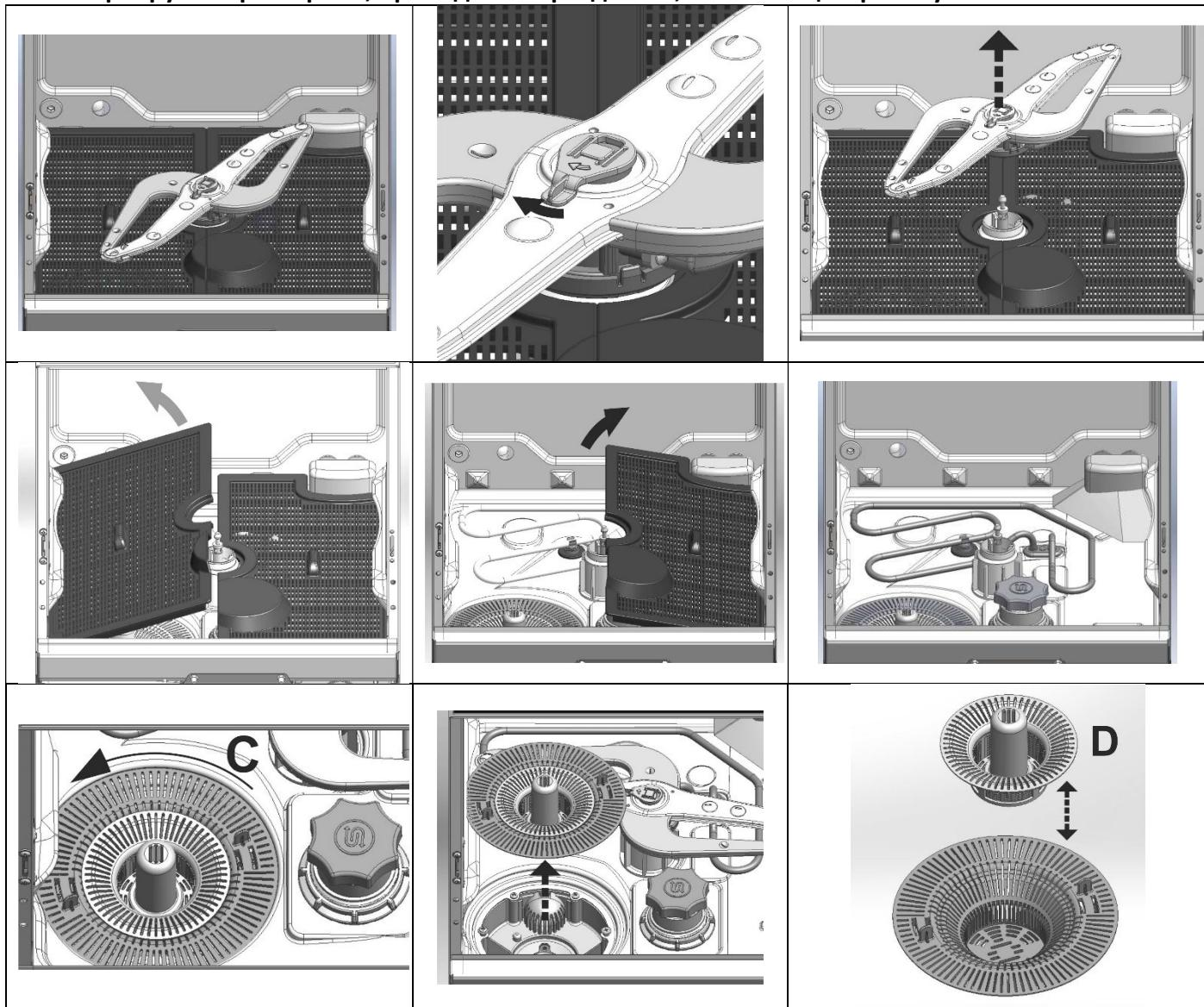
Процедура демонитрования фильтров с двумя фильтрующими элементами:
